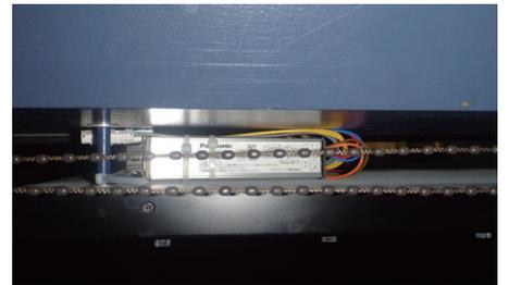
電源と既設看板の間に設置されたLinkRay固定ID変調機
