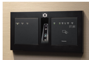
▶入居スペースの入り口に設置した壁掛けタイプの認証装置「KPASチェッカー」
