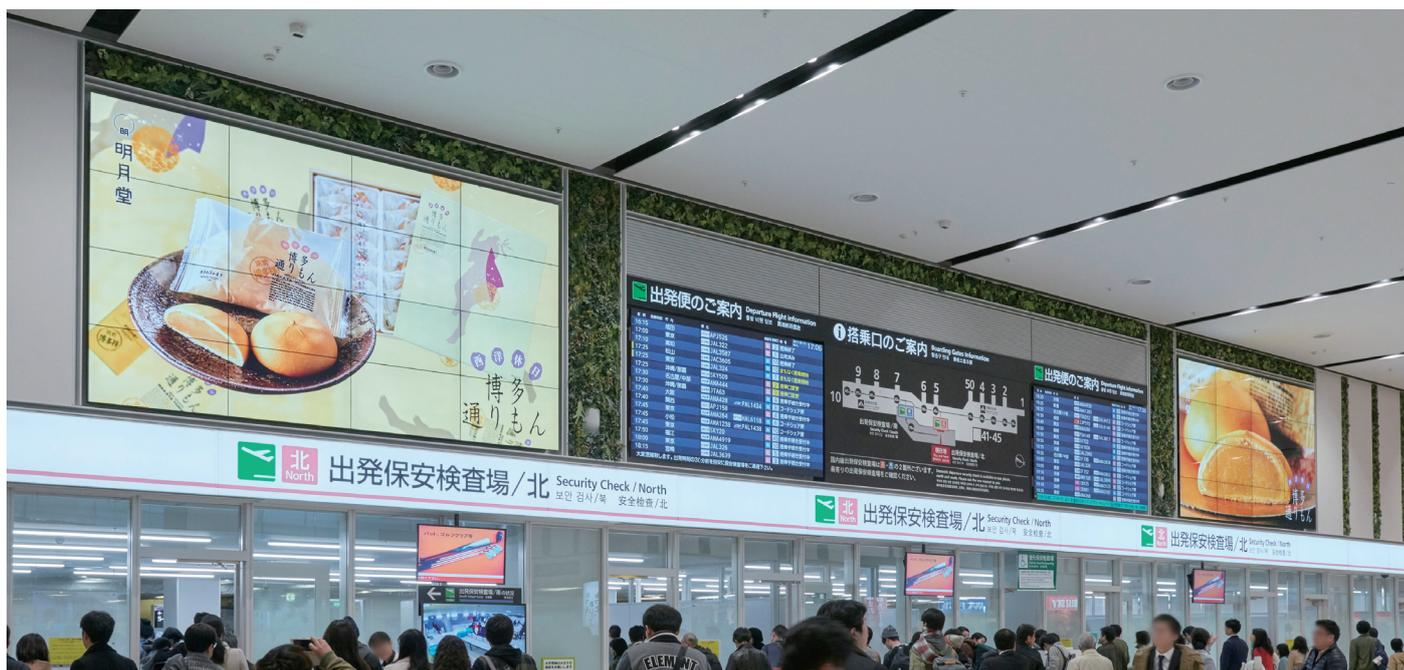
▲超狭額縁デザインで広告映像を自然に表示。TH-55LFV60J・縦4面×横4面の大型マルチディスプレイを出発口の左右に展開
