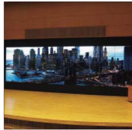
▲ダイナミックLEDバックライトとローカルディミングにより、高輝度かつハイコントラストを実現したディスプレイ。白浮きのない、しっかりとした黒色を表現する。
