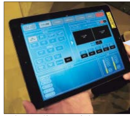
▲多目的に使用できる充実したシステムながら、タブレット端末あるいはタッチパネルで、入力ソースと表示パターンを選択するだけの簡単な操作を実現。
