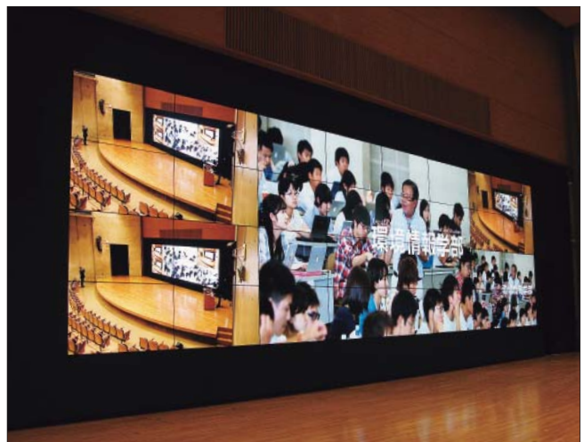
▲超狭額縁デザインのマルチスクリーン対応液晶ディスプレイを採用。ディスプレイ間のベゼル幅を3.5mmに抑えるため、文字情報の可読性も失わない。
