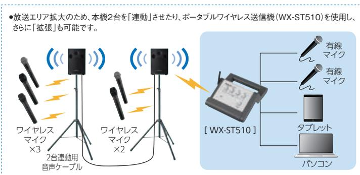
●放送エリア拡大のため、本機2台を「連動」させたり、ポータブルワイヤレス送信機 (WX-ST510) を使用し、さらに「拡張」も可能です。
