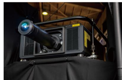
▲ 魚眼レンズET-D3LEF70を装着した3チップDLP®レーザープロジェクターPT-RQ22KJ。人の影がスクリーンに入り込まないよう、台の上に設置
