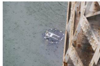
▲点検のために潜行する水中ロボットROV (右の鉄壁が主放流予備ゲート)
