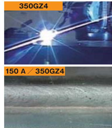
継手: すみ肉 母材: 軟鋼 SPCC (板厚: 2.3 mm) 溶接電流: 150 A
