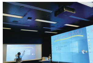
▲投写画像に書き込みができ、データを丸ごと保存することができる電子黒板システム
