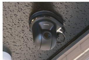
▲天井に設置されたりリモートカメラAW-HE75K。自動追尾ソフトウェアとの連携により講義を自動で撮影可能
