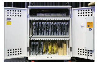
▲40台導入したレッツノートCF-SV8を一括で充電、システムバージョンアップが可能な保管ラック
