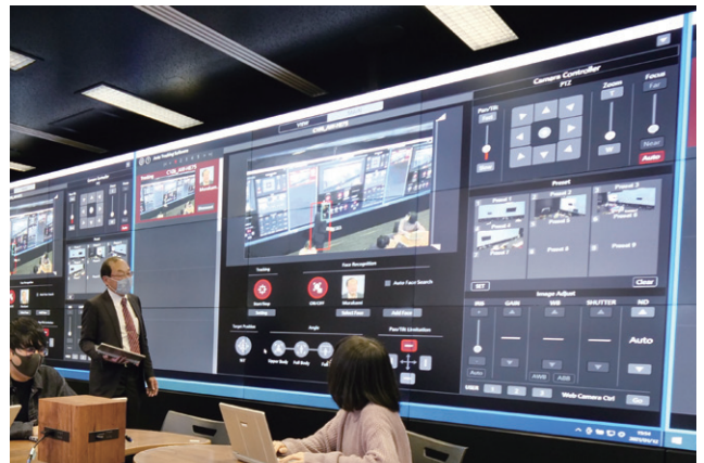
▲マルチディスプレイに映し出されているのは自動追尾撮影システムの制御画面。上部にはリモートカメラの映像が表示され、しっかりと教員を捉えている様子が確認できる
