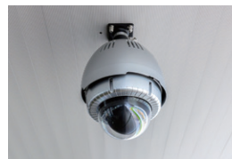
▲入場やファンファーレなどのタイミングの確認用に、実況放送室のバルコニーへ設置されたHDインテグレートドカメラAW-HE70SK9(屋外用ハウジングに格納)。地下馬道にも1台設置されている
