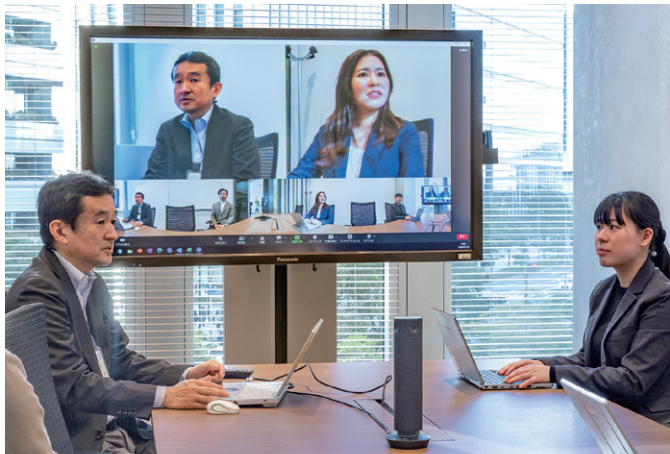
▲ 話者の声を認識して上部に2名を拡大表示し、下部には360度全体を表示する「分割ビュー」の画面
